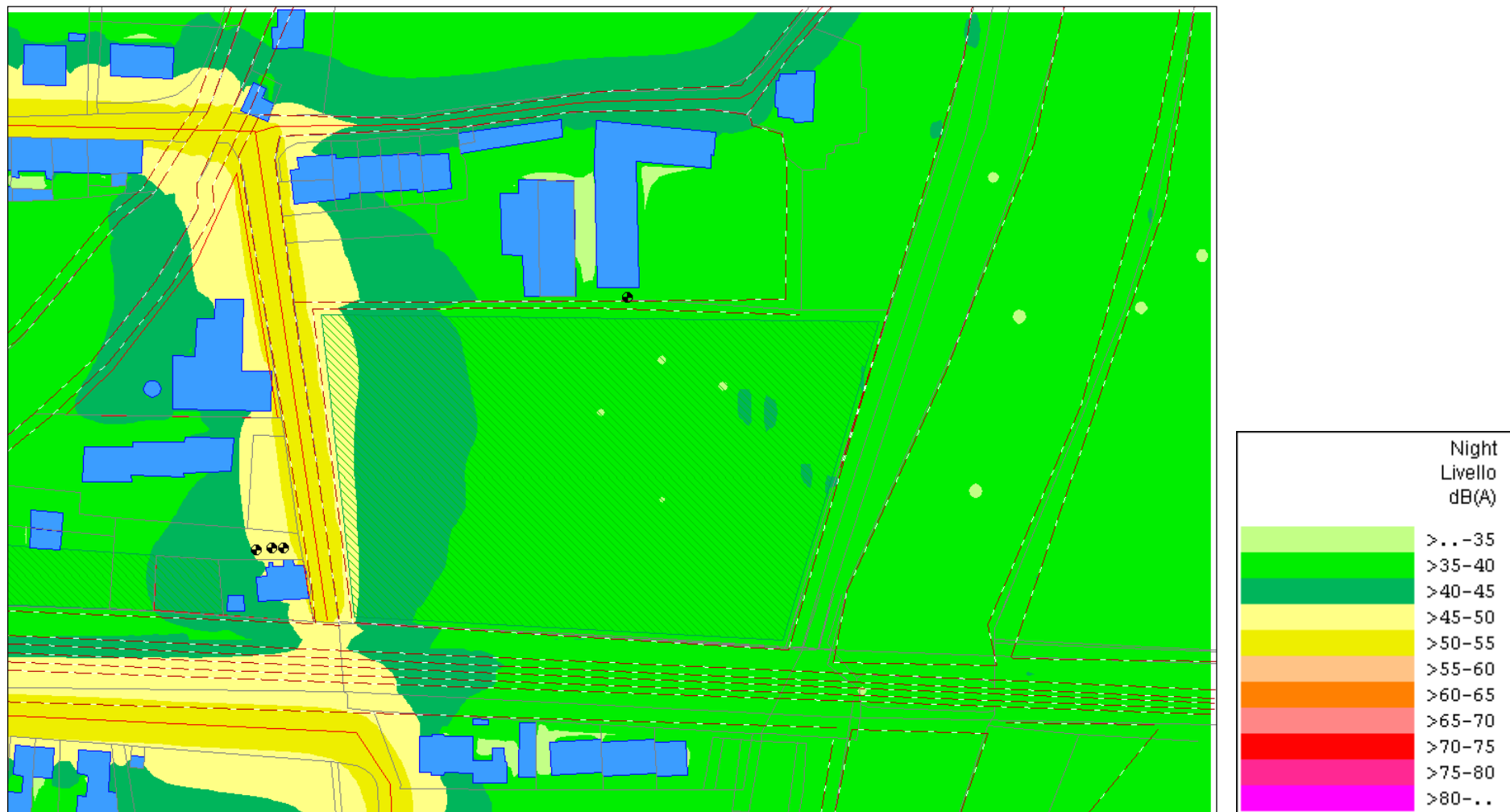
Figura 15 – Griglia di calcolo ai 4msul piano di campagna (altezza relativa) – Solo contributo sonoro delle strade e rumore di fondo (periodo notturno)
